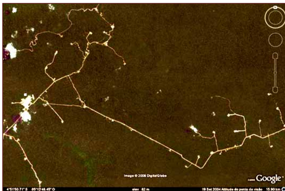
Trecho da área produtora de Urucu, Estado do Amazonas, e suas estradas de serviço. No lado esquerdo, no meio, a área industrial, no canto acima, o rio Urucu; numa área de 18 km por 12 km, pode-se contar duas dúzias de poços no meio da selva.
